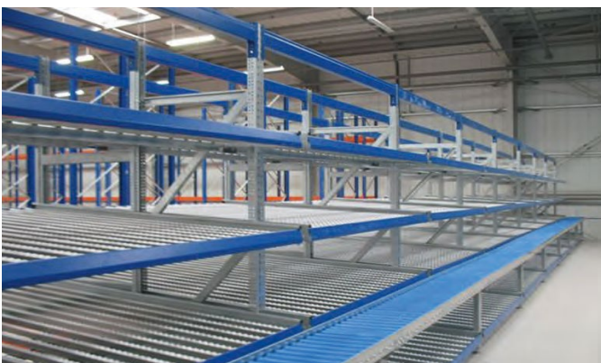
Implantation d'un système dynamique pour faciliter les flux dans une zone de picking et préparation de commandes (Habrial Manutention)
