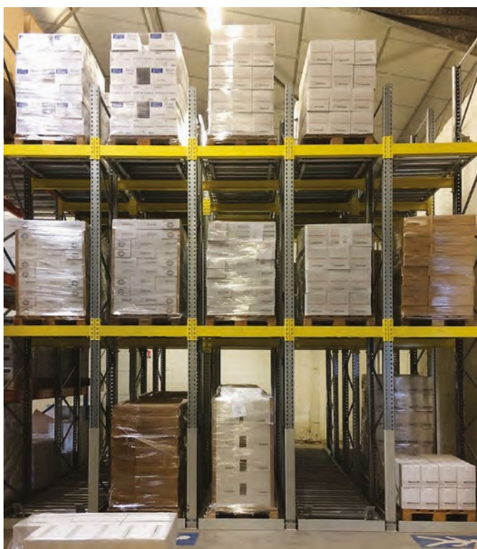
Espace de stockage de matières premières optimisé grâce au système LIFO (Poitou Rayonnages)
