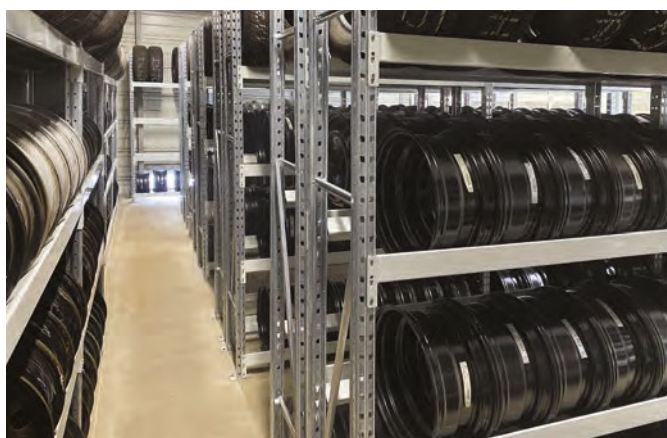
Installation de rayonnages sur deux étages dans un espace de stockage de jantes et de pneus, pour permettre la rotation classique suivant les saisons (Optim'est)
