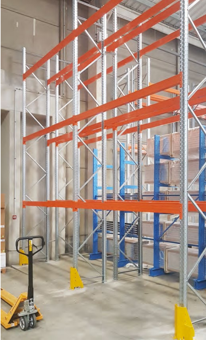
Rack standard en grande hauteur avec 3 niveaux de stockage (DDI)
