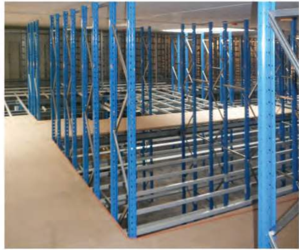
Een bandenmagazijn van een autodealers op de begane grond en op 2 etages, om een maximaal aantal referenties voor alle seizoenen op te slaan (Marc Van Ackere)
