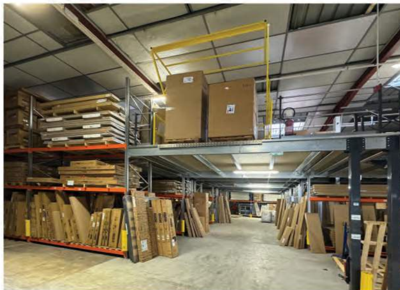
Ophaalzone van een meubelwinkel en een winkel in huishoudtoestellen, ontworpen met een combinatie van pallettracks en mezzanines om te voldoen aan de eisen van de normen, het vloeroppervlak en het gewicht van de opgeslagen of behandelde lasten (Avas Equipment)
