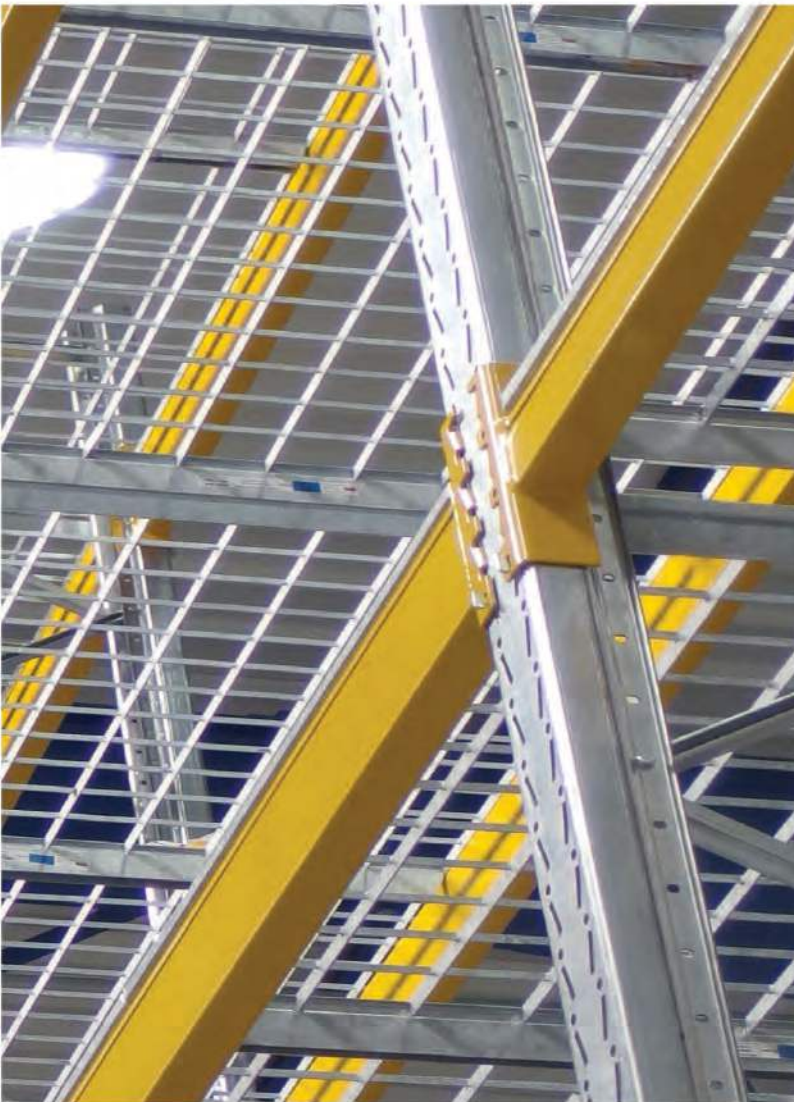
Roosterlembord: voor zware goederen, stevige en beveiligde drager, dankzij de thermisch verzinkte afwerking en de in de randen geïntegreerde verstevigingen; voldoet aan de brandveiligheidsnormen voor de doorvoer van water in ruimtes die zijn uitgerust met een sprinklersysteem
