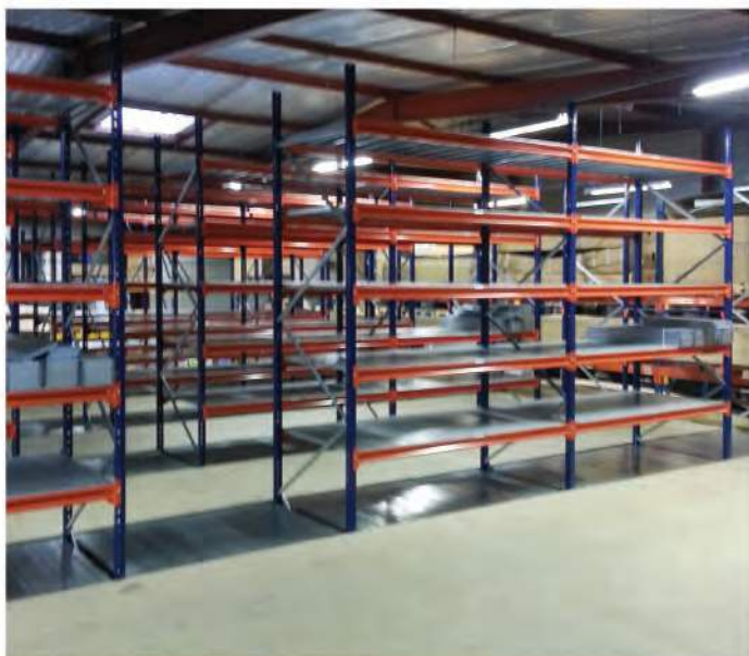
ACTI-RACK-stellingen geïnstalleerd over de volledige hoogte van het gebouw, met standaard spaanplaatvloeren en metalen legborden om de doorgangen op de opslag niveaus te beveiligen (Classotech)
