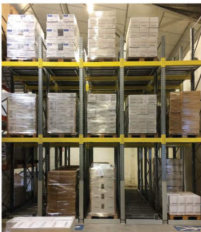
Geoptimaliseerde opslagruimte voor grondstoffen dankzij het LIFO-systeem (Poitou Rayonnages)
