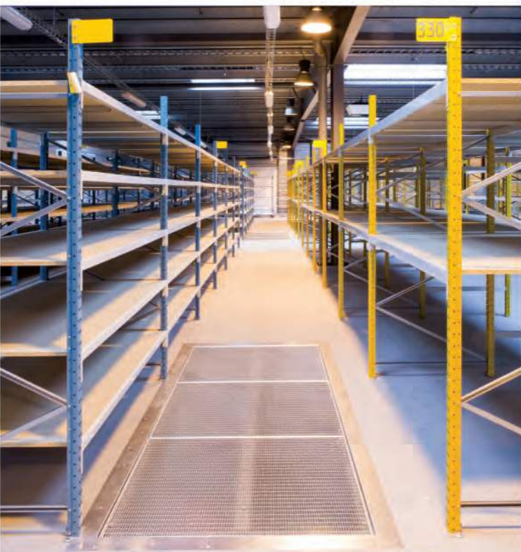
Installatie van stellingen die gepersonaliseerd zijn met een nummeraanduiding en verschillende kleuren, voor een snelle en efficiënte identificatie van opslagzones voor onderdelen
