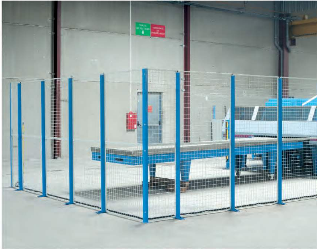
Veiligheidszone rond een ponsmachine afgebakend door gaaswanden (Actiflip)
