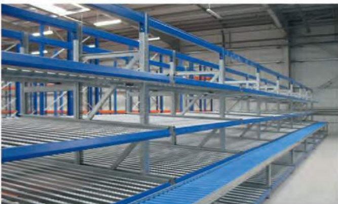
Installatie van een dynamisch systeem om de stromen in een verzamel- en ordervoorbereidingszone te vergemakkelijken (Habrial Manutention)
