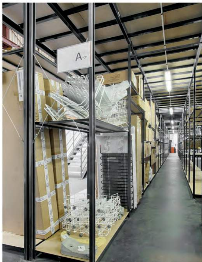
Opslagmagazijn voor kleine en grote huishoudtoestellen, inclusief onderdelen, met verschillende niveaus afhankelijk van de elementen die worden opgeslagen (Avas Equipment)
