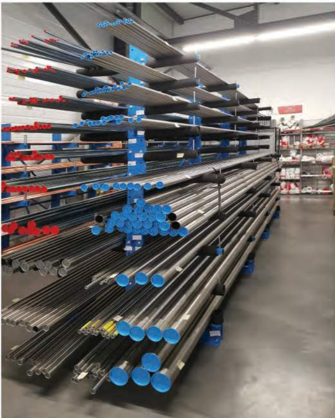
ACTI-CANT dubbelzijdig, voor het opbergen van ijzeren staven van verschillende afmetingen in een metaalwerkplaats (Araydis)
