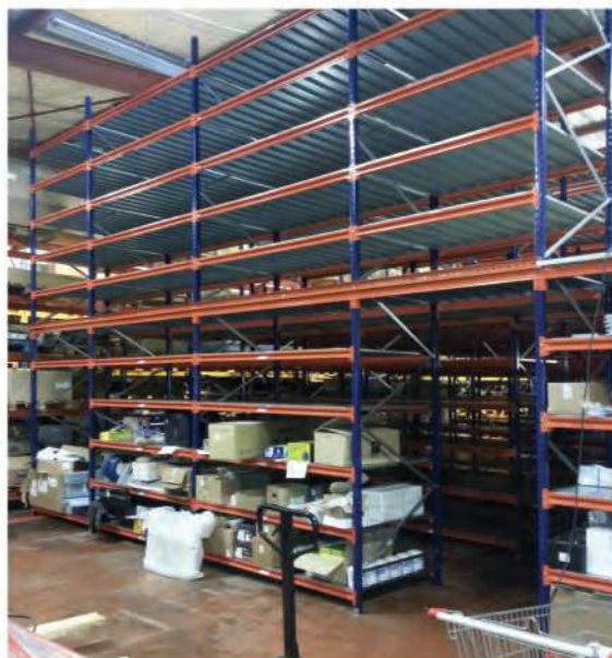
ACTI-RACK-stellingen geïnstalleerd over de volledige hoogte van het gebouw, met standaard spaanplaatvloeren en metalen legborden om de doorgangen op de opslag niveaus te beveiligen (Classotech)
