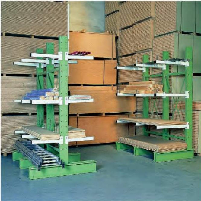
Horizontale opslag van spaanplaatpanelen op enkel- en dubbelzijdige structuren, gepersonaliseerd in de bedrijfskleuren van de klant
