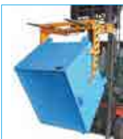
Lediging middels traverse of draaiapparaat
