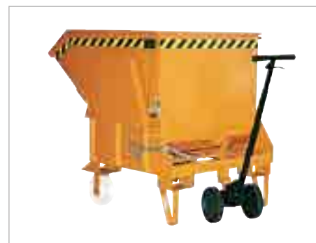
BK met opname voor hefboomroller Type B2
