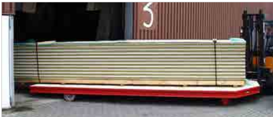
Transport van lange materialen, kleine draaicirkel d.m.v. directopname
