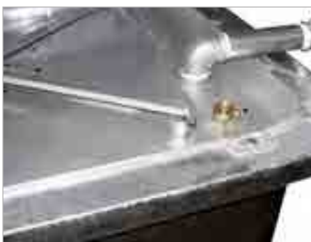
Peilstok voor vulstandcontrole
