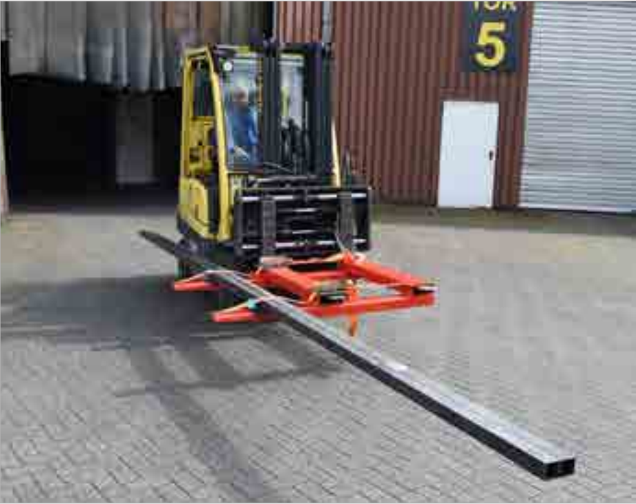
Opnamepositie voor transport b.v. door poorten en gangen
